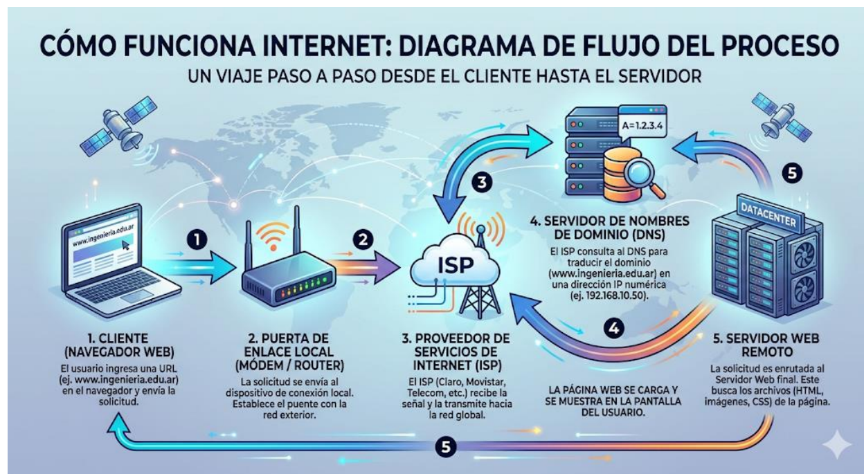
Figura 12.2 — Comunicación entre computadoras_Cómo funciona Internet.
